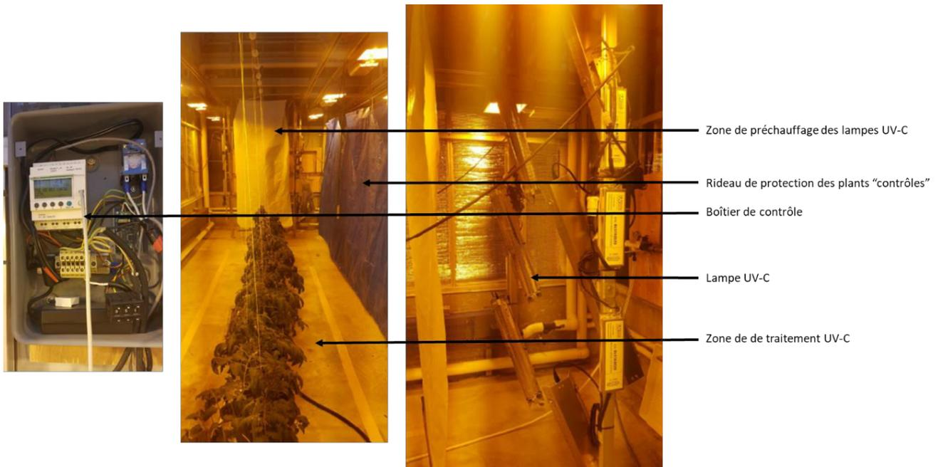
Figure 51 : Traitements UV-C des plants de tomate sous serre. Un portique contenant 6 lampes UV-C se déplace automatiquement le long des plants de tomate pour délivrer une dose UV-C choisie de 0,20 kJ/m<sup>2</sup>.
