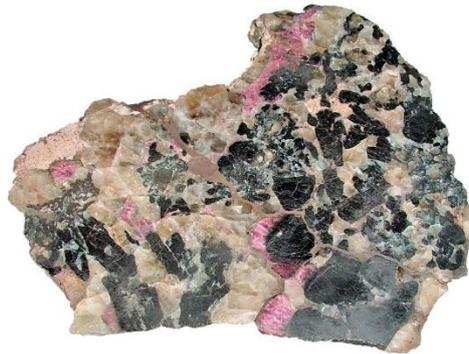
**Figure 5 : Specimen scié et poli sur une face**, montrant des cristaux de quartz gris sel, des feldspaths blanchâtres et des cristaux de tourmalines noires, roses et vertes. La couleur rose et verte est due à la présence de Manganèse et de lithium dans la structure du minéral, les tourmalines ferrifères sont noires. Il fait partie des roches magmatiques filoniennes.
