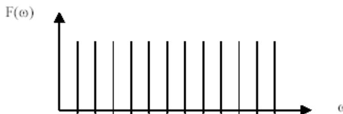
Fig. III.5. Un balayage en fréquence
