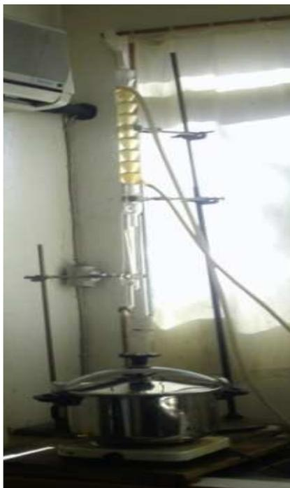
**Figure 7** : Autocuiseur transformé en extracteur de HE type Clevenger
