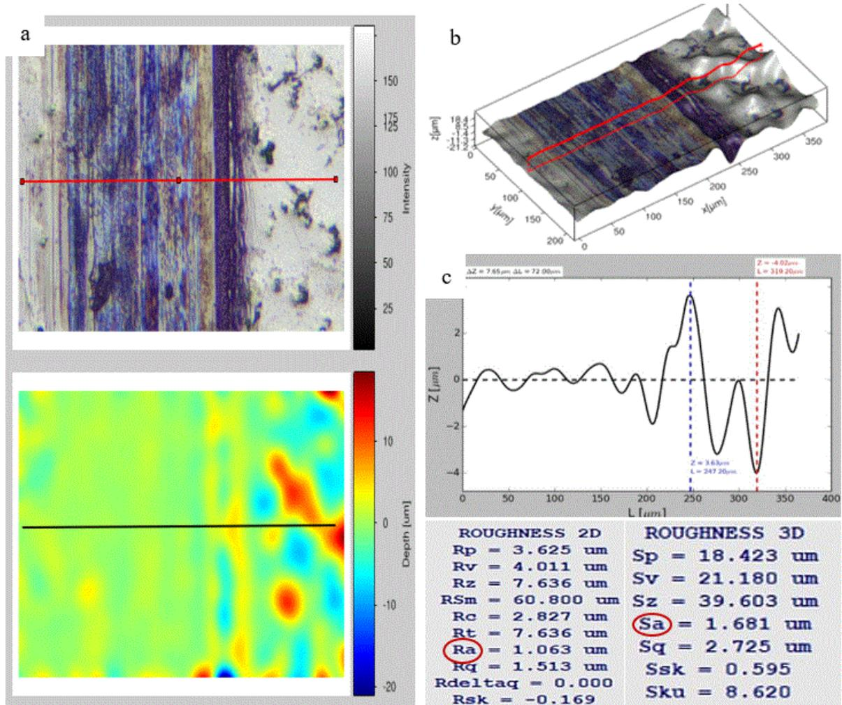
**Figure III.36.** Micrographies optiques 2D (a) et 3D (b) et rugosités Ra et Sa (c) de l'échantillon A1 traité à 1100°C après le test tribologique à l'état lubrifié
