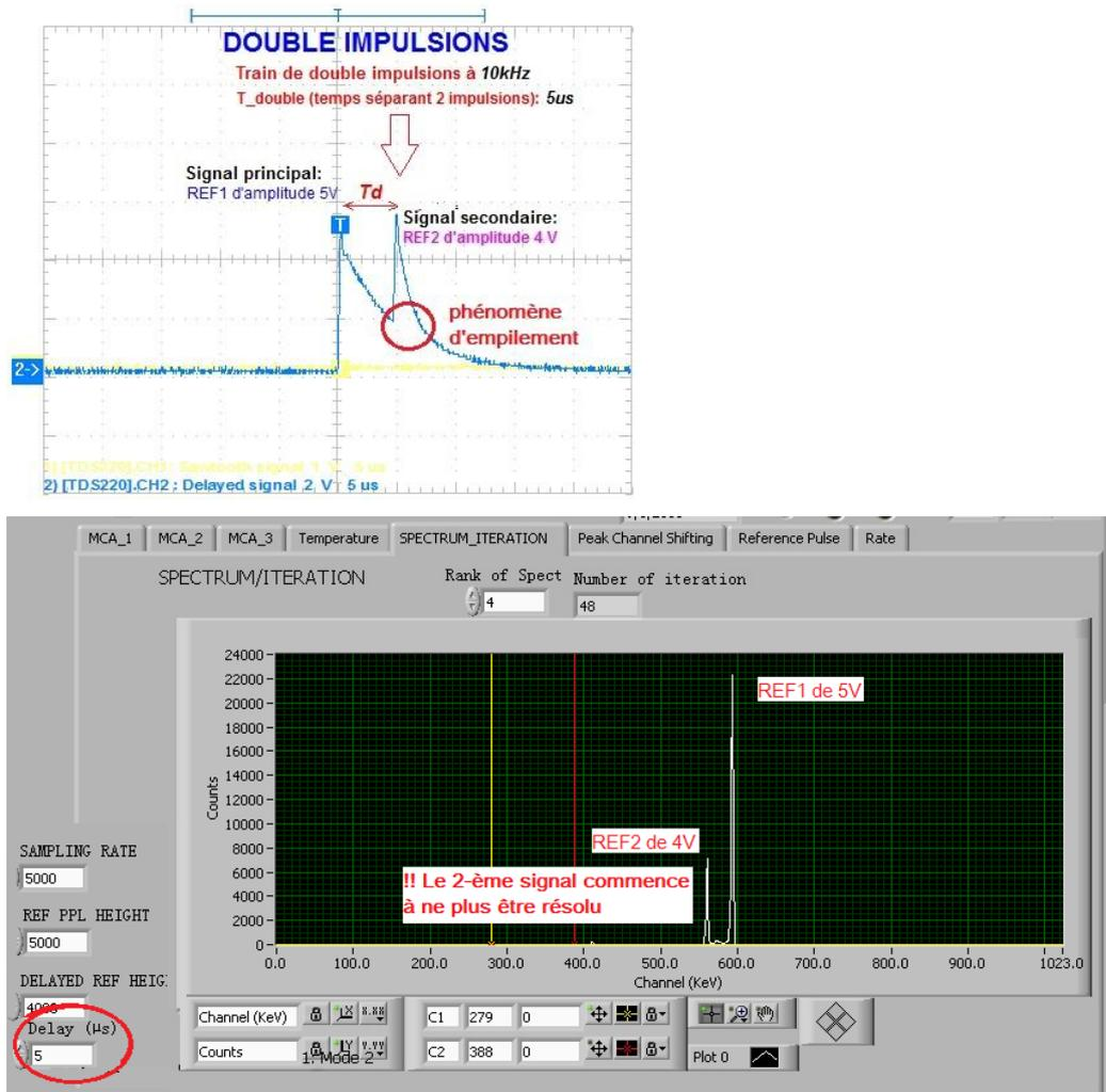
Figure-6. 14 : Visualisation et capture du spectre du train de "Double Impulsions" sur le programme d'interface programmé sous Labview
