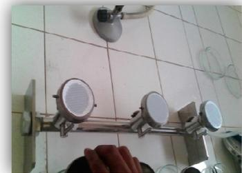
Photo 4 : Appareil de filtration
