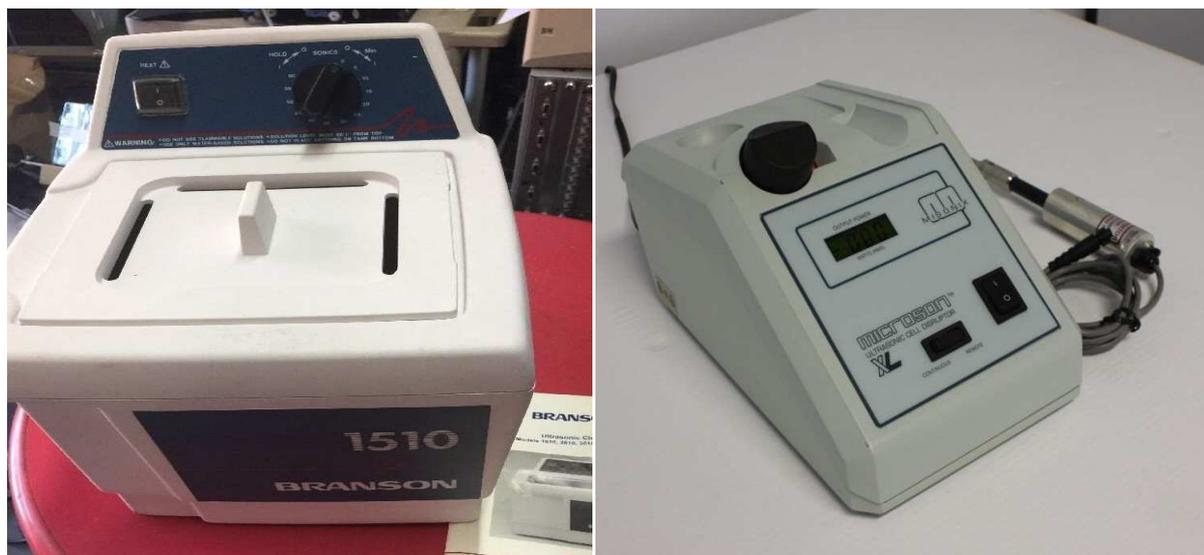
**Figure 2.** Système à ultrasons utilisé, Branson 1510E-MTH et Misonix XL2000.
