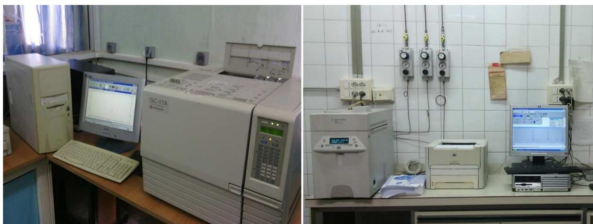
**Figure 3.** CPG utilisée, GC-17 SHIMADZU et Agilent Technologies 6850.
