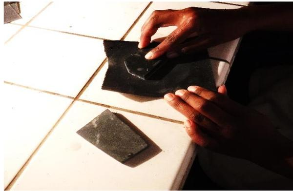
**Figure 10:** Elimination des traces de scie de l'échantillon par l'utilisation d'un papier vert faite de silice.
