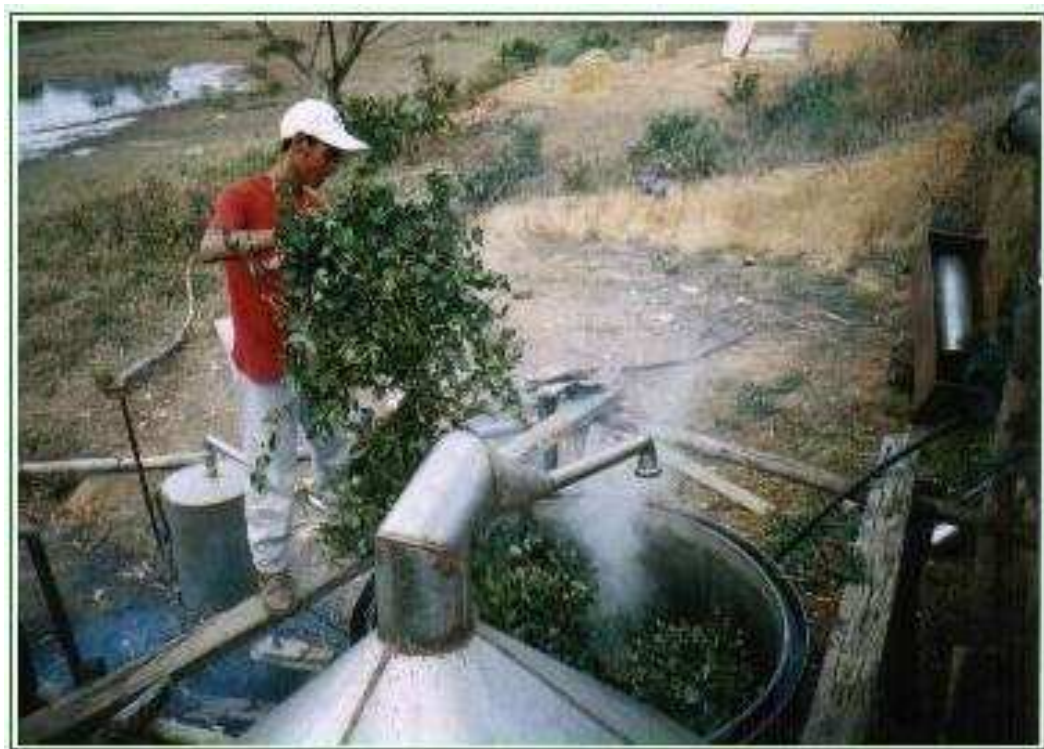
Figure n°9 : Chargement de la cuve florale.
