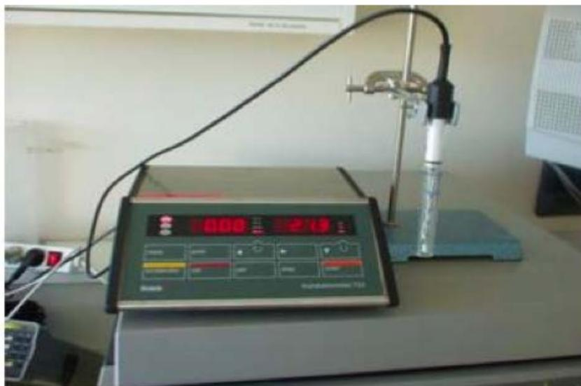
Figure 12 : Un conductimètre [23]
