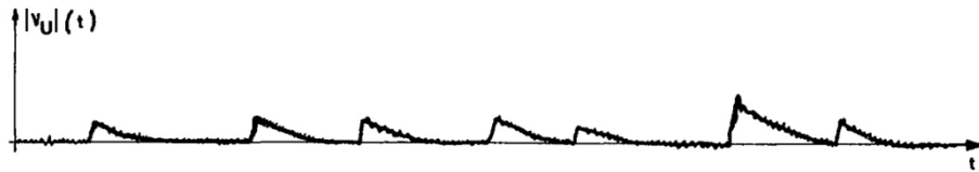
Figure-3. 9 : Cas d'un débit \tau < \tau_d = R_D \cdot C_D
