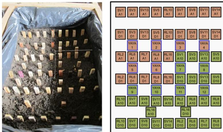
Figure 41 : Disposition des éprouvettes dans le bac.
