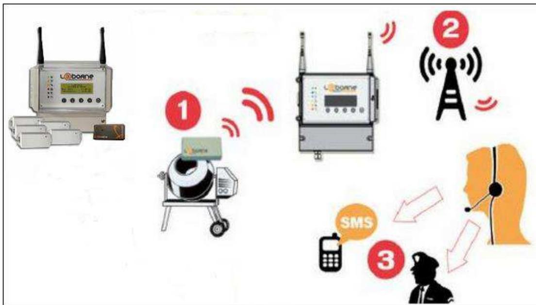
Figure 24: Application RFID active pour la surveillance anti-vol
