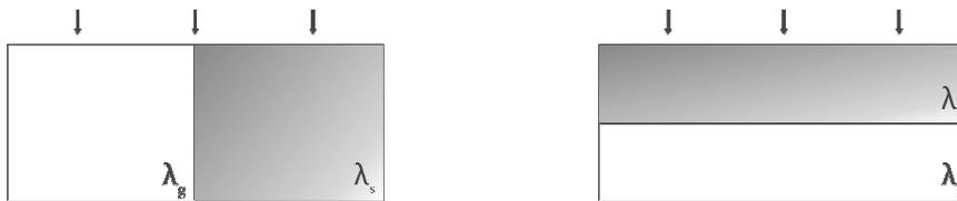
Un flux parcourant un matériau avec une microstructure établie sous la forme de strates ne se voit cette fois proposé aucuns chemins préférentiels et s'avère alors ralenti par les plans successifs de porosité. La chaleur ne pourrait effectivement traverser le matériau que par un franchissement des strates une à une selon une simple loi en série se modélisant ainsi sous la forme de l'équation suivante :
