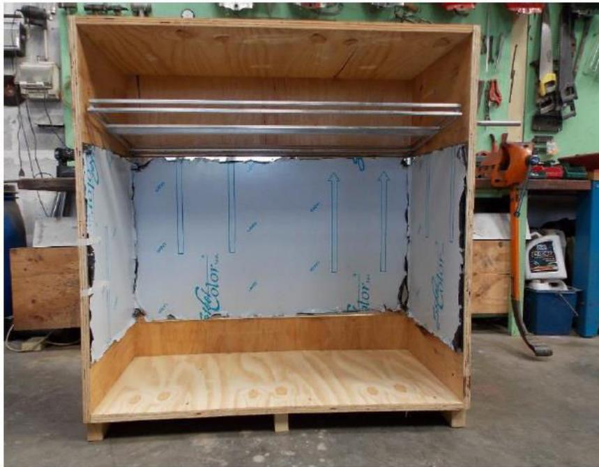
**Figure 68 : Enceinte en cours de construction.** Les tôles en inox sont revêtues d'un film plastique qui protège de l'oxydation, et qui sera retiré au dernier moment. On aperçoit également le support des lampes et des ballasts. (Photo : Frédéric Pascal, INRA PACA).
