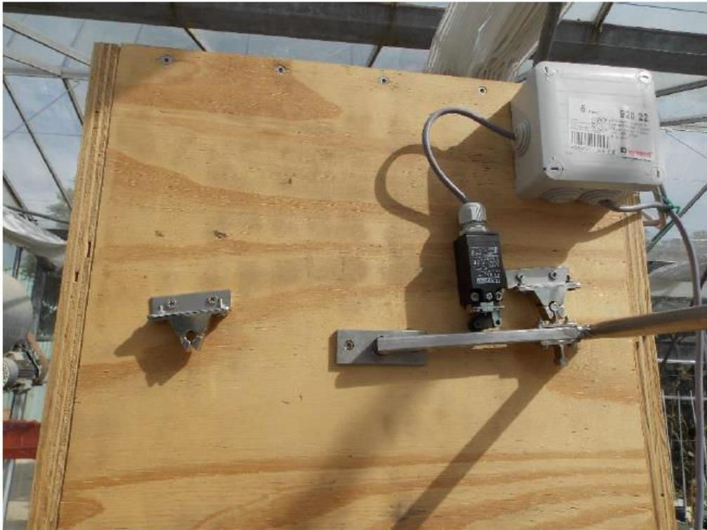
Figure 72 : **Manivelle et loquets maintenant la position.** On voit également le contact électrique de sécurité. (Photo : Frédéric Pascal, INRA PACA).
