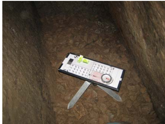
Figure 1 : Mire de référence spatiale en situation, placée à l'horizontale et orientée au nord avant d'être modélisée dans la scène enregistrée.
