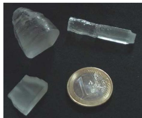
Photo III.4.1 : Quelques cristaux de SYS (dopé 5.5at. % Yb). Photo LCAES.
