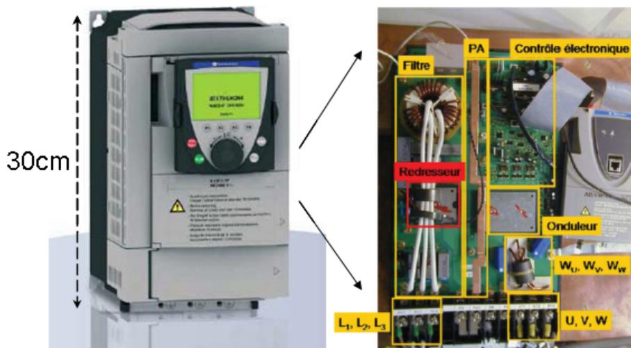
Figure V.13 – Variateur de vitesse de STIE : ATV71 230 V / 5,5 kW
