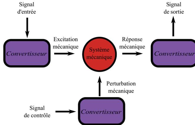
Figure 1.2 – Schéma du principe général d'un NEMS
