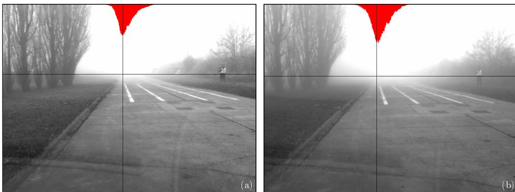
FIG. 4.21 – Extraction de la position de ligne d'horizon
