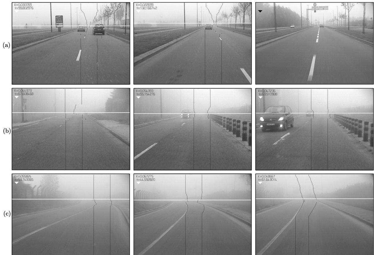
FIG. 4.4 – La ligne blanche horizontale représente l'estimation de la distance de visibilité. Le petit triangle blanc en haut à gauche indique que le système est opérant, alors qu'en noir il est temporairement inopérant.
