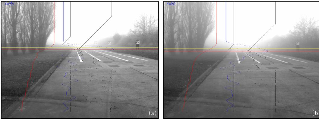
FIG. 4.22 – Mesure de la distance de visibilité météorologique sur images réelles : (a)  $\tilde{V}_{met} = 95m$ ,  $\hat{V}_{met} = 94m$  ; (b)  $\tilde{V}_{met} = 61m$ ,  $\hat{V}_{met} = 61m$ .
