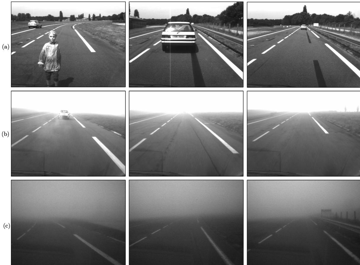
FIG. 4.6 – Images capturées à bord du véhicule (a) par beau temps; (b) par temps de brouillard; (c) par temps de brouillard à la tombée de la nuit.
