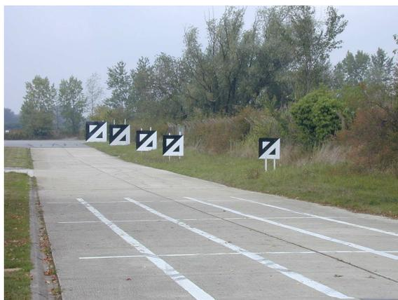
FIG. 4.13 – Les cinq mires fixes de calibrage installées sur les pistes de Satory.
