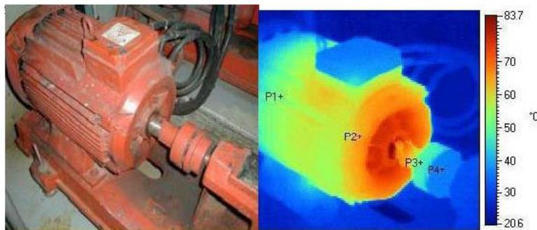
Figure III.12 Détection des défauts par la caméra infrarouge [54]
