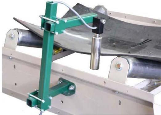
Figure III.11 Surveillance du désalignement de la bande [49]
