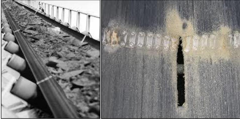
Figure II.10 Rupture de la bande au niveau des jonctions [10]
