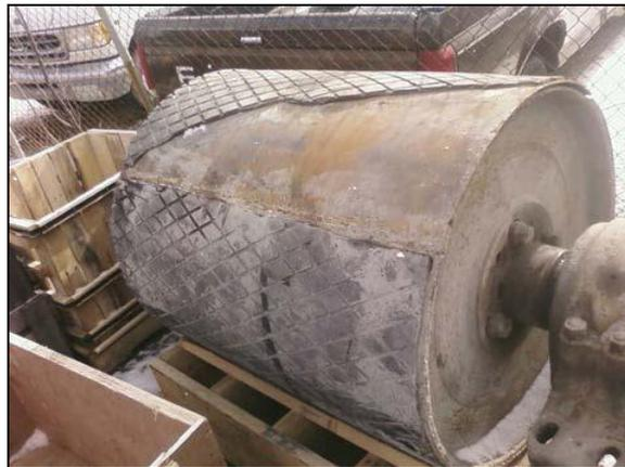
*Figure II. 11 Usure du garnissage du tambour moteur*
