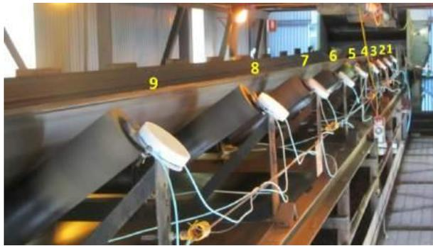
Figure III.15 Surveillance de température à base des fibres optiques [56]
