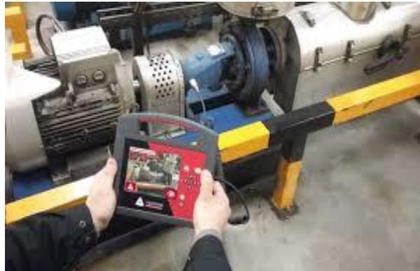
Figure III.10 Détection des défauts par l'analyse vibratoire [54]
