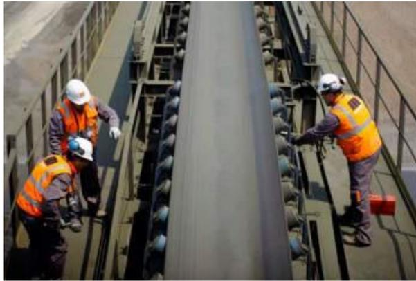
Figure III.1 Inspection humaine du convoyeur à bande [56]
