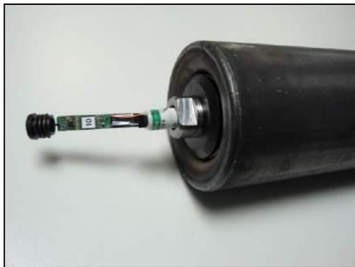
Figure III.14 Le rouleau du support intelligent [56]
