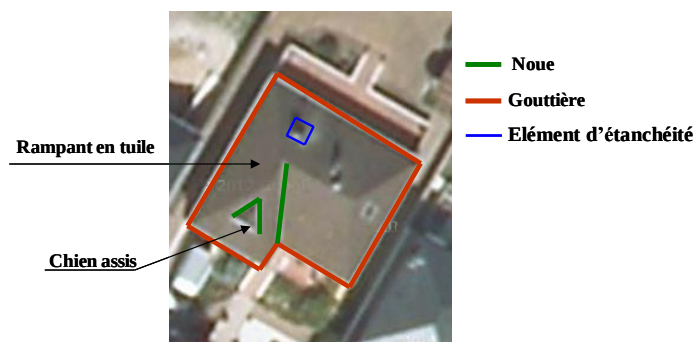
Figure 125 : Repérage de la famille de matériaux de rampant, de gouttières et de noues dans une toiture à partir d'une photo-aérienne
