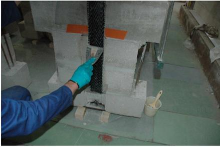
*Figure 5.19* — Mise en place du TFC
