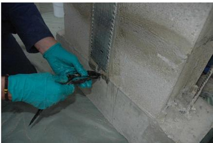
*Figure 5.15* — Scellement d'une mèche
