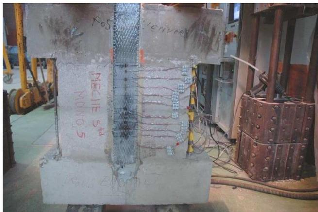
*Figure 5.26 — Jauges de déformation*
