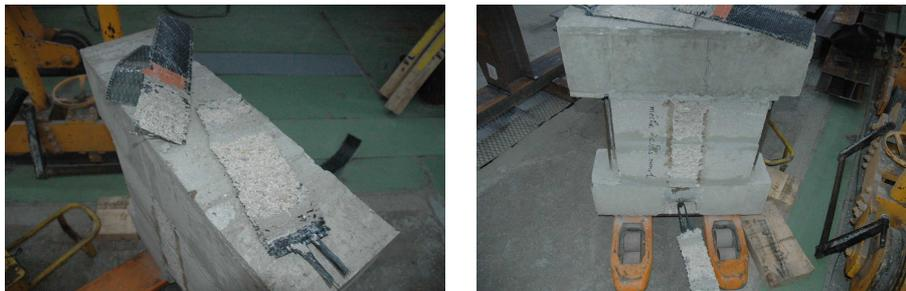
*Figure 5.44* — Mode de rupture observé lors des essais avec ancrage de type mèche à chas
