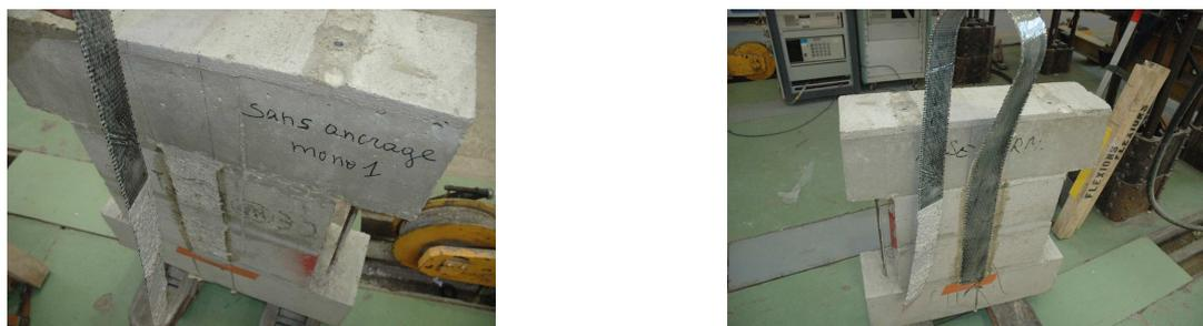
**Figure 5.28** — Délaminage observé lors des essais sans ancrage
