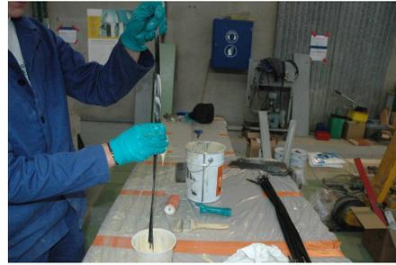
*Figure 5.20* — Imprégnation des fibres de carbone
