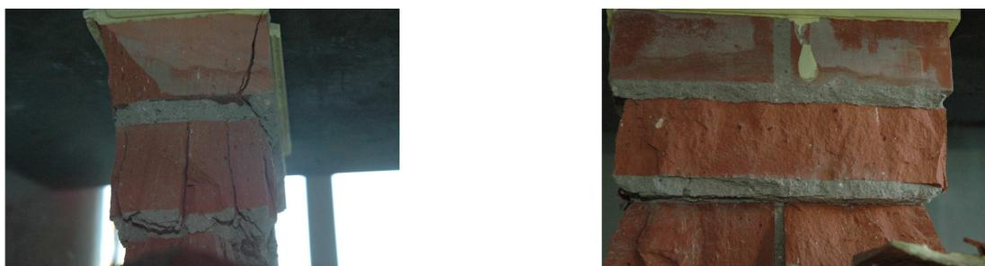
**Figure 3.12** — Mode de rupture de l'échantillon  $B_2$
