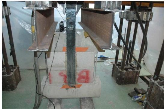
Figure 5.23 — Fixation de l'échantillon dans le bâti d'essai
