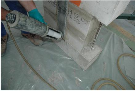
*Figure 5.13* — Injection de colle dans les trous
