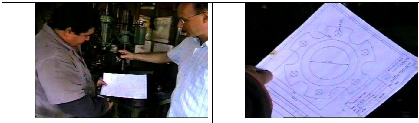
FIGURE 22 : LE DESSIN POUR LE PERÇAGE DU MOYEU DE ROUE
