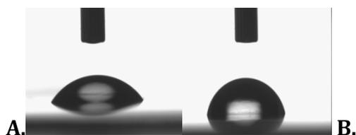
Figure 73: Mesure des angles de contact (eau distillée) sur l'électrode a-CN<sub>x</sub> A.) avant (32°) et B.) après (79°) fonctionnalisation par un groupement thiophénol dans 5 mM NaNO<sub>2</sub>.  $V_b=100$  mV.s<sup>-1</sup>.
