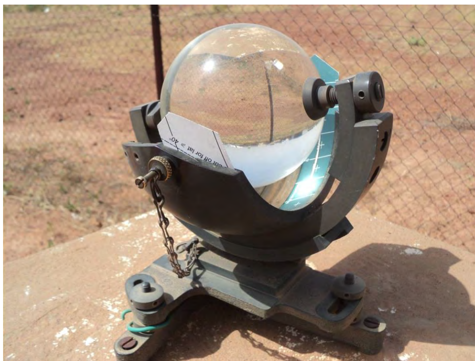
Figure 13: Instrument de mesure de la durée d'insolation du service de la météorologie nationale de N'Djamena (DGNM, 2017).
