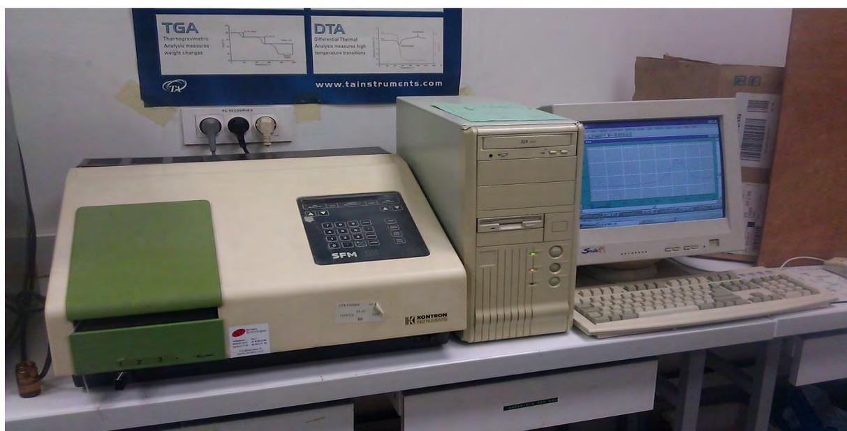
**Figure II-2.** Spectrofluorimètre KONTRON SFM-25 utilisé en PIF classique.
