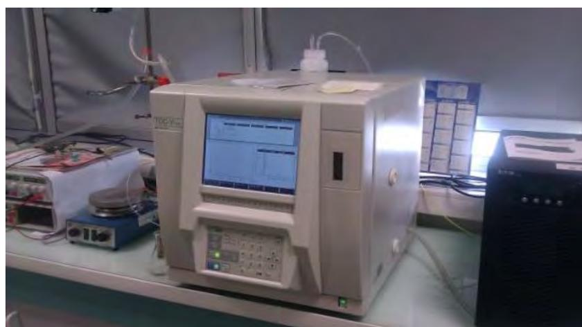
**Figure II-5.** Photographie de l'analyseur du carbone organique total (COT).
