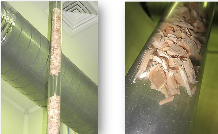
**Figure 36** : Formation de voûtes dans un tube lisse.
