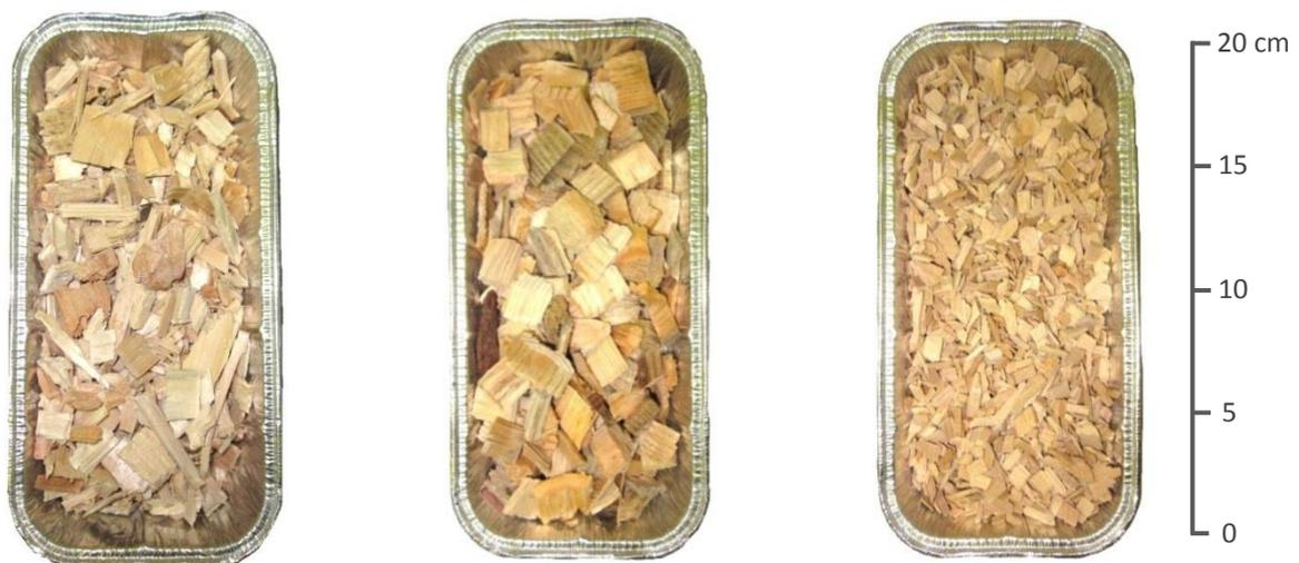
**Figure 35** : Les trois types de biomasses testées pour l'injection dans le four tournant pilote :
