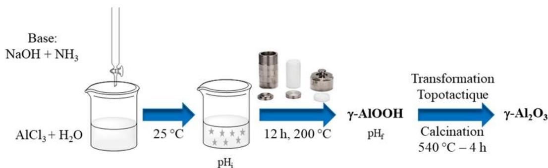
Figure 38: Protocole de synthèse hydrothermale par précipitation de sel d'aluminium à pH acide
