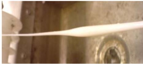
**Figure 27** Aspect du jonc en sortie d'extrudeuse dans le cas des mélanges non-compatibilisés – Exemple du mélange PBS/PBT 75/25
