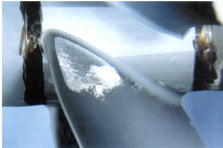
Figure 1.4. Cavitation à poche partielle ; photo BEC
