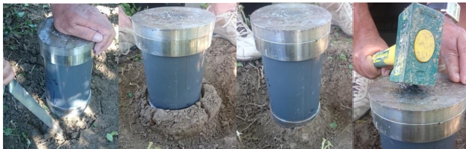
Figure II – 2 : Photos échantillonnage colonne Verger (23/06/2016) (haut gauche : Dégagement du pourtour de l'échantillon ; Haut droite : Enfoncement ; Bas gauche : Dégagement autour de la colonne en profondeur ; Bas droite : Frappe sur les pièces d'enfoncement (martyr et réhausse).
