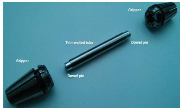
(b) Configuration d’essai d’un AMF de NiTi.
