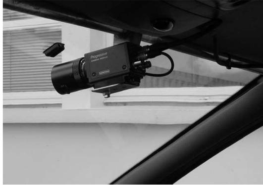
FIG. 2.1 – Disposition de la caméra dans le véhicule.
