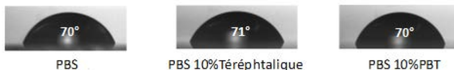
Figure 14 Mesure de l’angle de contact avec une goutte d’eau des copolymères du PBS avec l’acide téréphtalique et le PBT
