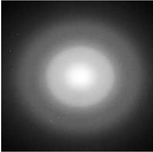
FIG. 5.6: Cliché de diffraction de la zone d'olivine transparente aux ions  $\text{He}^+$  à 10 keV. Le halo diffus que l'on peut observer et l'absence de structure (point ou anneaux) sont caractéristiques d'une structure complètement amorphe. Des clichés semblables ont été obtenus pour les échantillons irradiés par des ions  $\text{He}^+$  de 4 keV pour toutes les doses (de  $5 \times 10^{16}$  à  $10^{18}$  ions/cm<sup>2</sup>).
