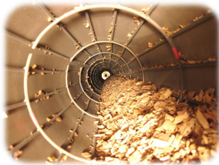
Figure 42 : Photographie réalisée pour l'identification du profil de chargement du cylindre.
