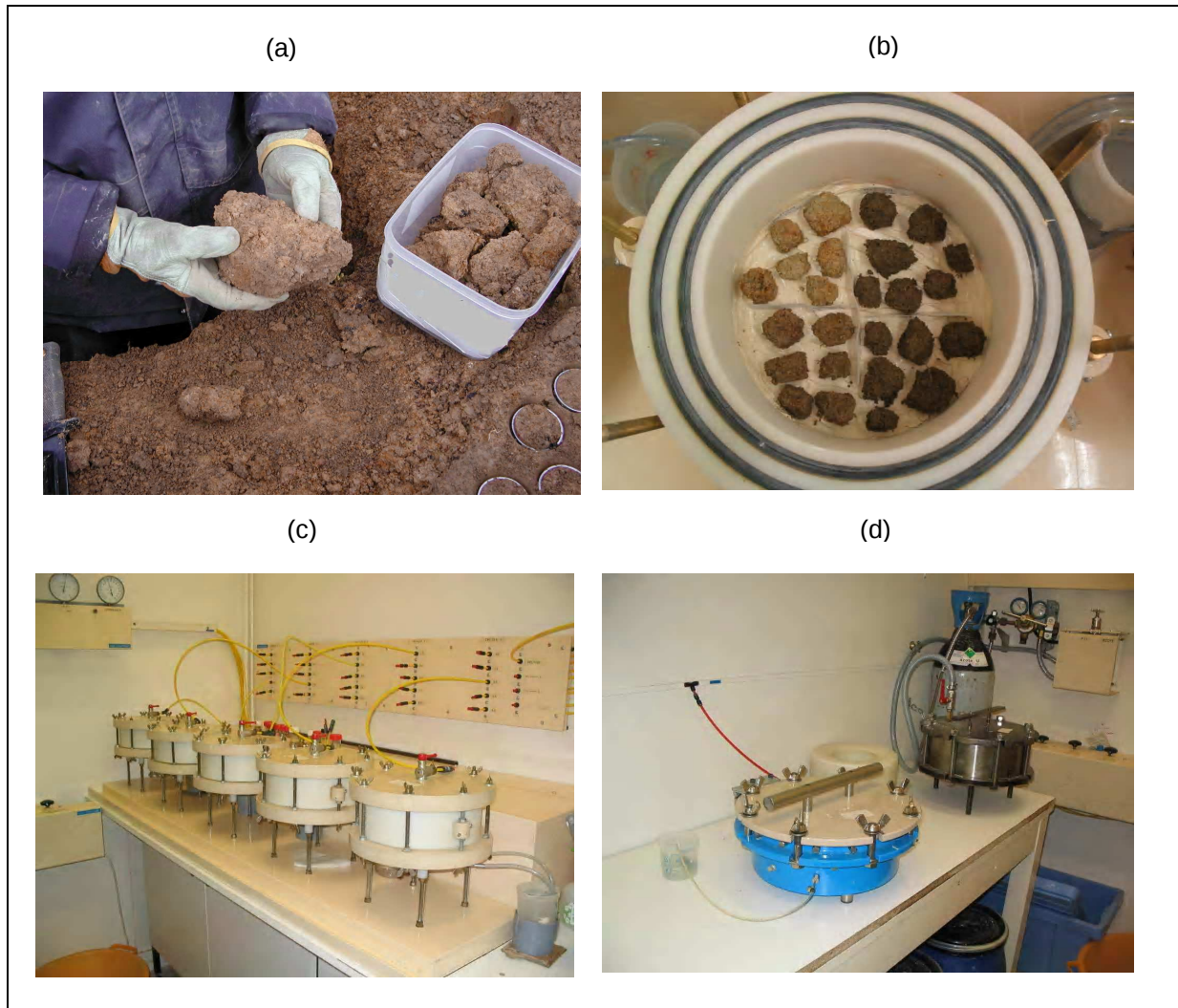
Figure 2.3 : (a) Echantillons de taille décimétrique non perturbés (blocs ou mottes) collectés sur le terrain, (b) mottes disposées sur une pâte de kaolinite, (c et d) cellule à pression utilisée pour mesurer la teneur en eau des mottes mises à l'équilibre avec un potentiel donné.
