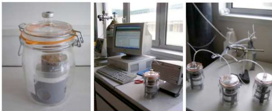
Figure II.2: Bocal d'incubation, dispositif de mesure de la concentration en CO 2 et système de renouvellement d'air.
