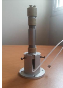
Figure 33 : Cellule d'écoulement sous scanner X.
