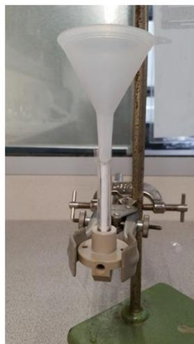
Figure 60 : Remplissage de la cellule avec les grains de silice.
