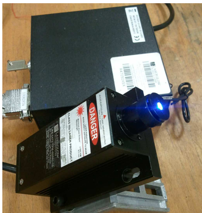
Figure 85: Laser Système Bleu 473 nm de Laserglow Technologies
