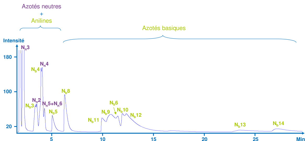
Figure 72 : Chromatogramme SFC-FID du mélange test MT N sur la colonne cyanopropyle (phase mobile : \text{CO}_2 à 250 bar, T = 65^\circ\text{C} , débit = 2 mL/min, dimensions de la colonne : 250 mm \times 4,6 mm, 5 \mu\text{m} ).
