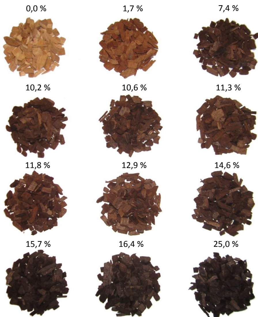
Figure 94 : Influence de la perte de masse sur l'aspect visuel des plaquettes de bois.
