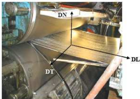
FIG. 6.16: Visualisation des axes DN ( y ), DL ( x ), DT ( z ) pendant le laminage d'une tôle.
