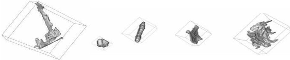
FIG. 6.33: Cinq différents types de particule de type Al_x(Fe,Mn) contenus dans AA5182 déformé à 10% de gauche à droite particules A, B, C, D, E
