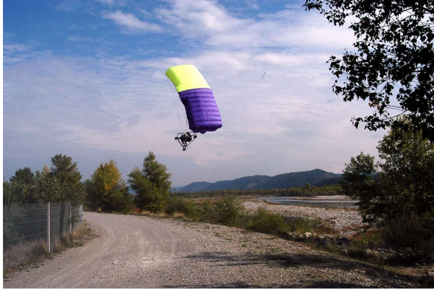
FIG. 6.1 - Le drone Pixy en phase de décollage court au bord de la Durance
