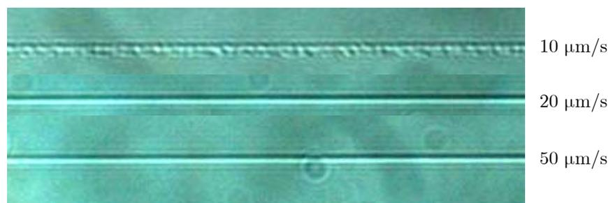
Figure 7.15 – Influence de la vitesse de translation sur la morphologie du guide, à énergie constante. Conditions expérimentales :  $\text{ON}=0.25$ ,  $1.5 \mu\text{J}$ ,  $130 \text{ fs}$ ,  $100 \text{ kHz}$ , 1 passage.
