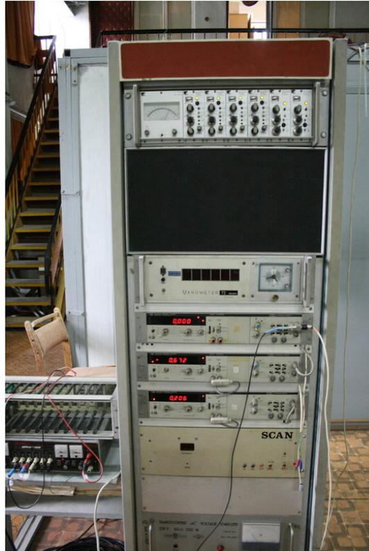
**Figure 5.9.** Photo des conditionneurs des capteurs de pression entrée de veine et de pression différentielle convergent
