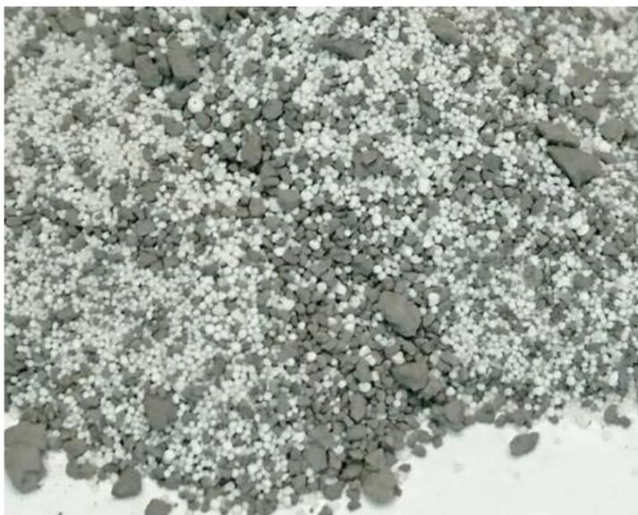
Figure 129 : Catalyseur utilisé après 300 h de réaction de tri-reformage à 800 °C, rapport molaire de départ  $CH_4/CO_2/H_2O/O_2 = 1,0/0,67/0,9/0,1$
